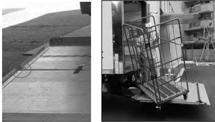
図2 床下格納式 TGL の側部ストッパー隙間と RBP の車輪が逸脱した様子 (例)
